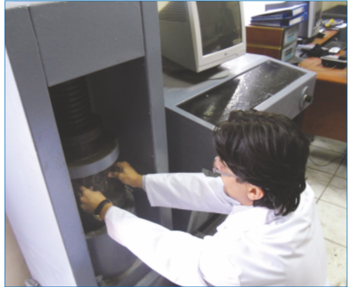
Beton numune küp mukavemet testi
